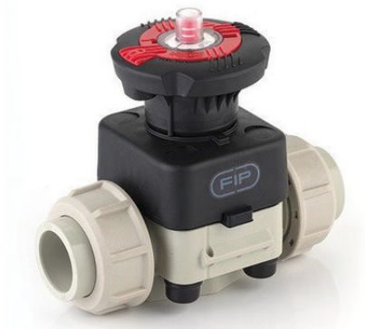
Мембранный клапан DKUIM с муфтовыми окончаниями (уплотнение EPDM / мембрана EPDM) PP-H d40 (DN32)
