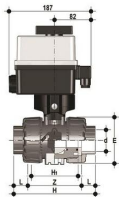
Шаровой кран VKD ХПВХ с эл.приводом 24V AC/DC, муфтовые окончания, DN65-100 d110 (DN90)
