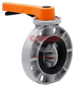
Затвор дисковый ХПВХ с рукояткой EPDM Comer d225 (DN200)
