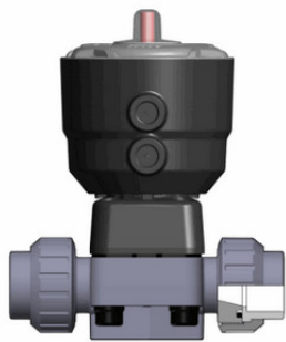
Мембранный клапан ДК ПВДФ с пневмоприводом НО, PN10 с муфтовыми окончаниями d63 (DN50)
