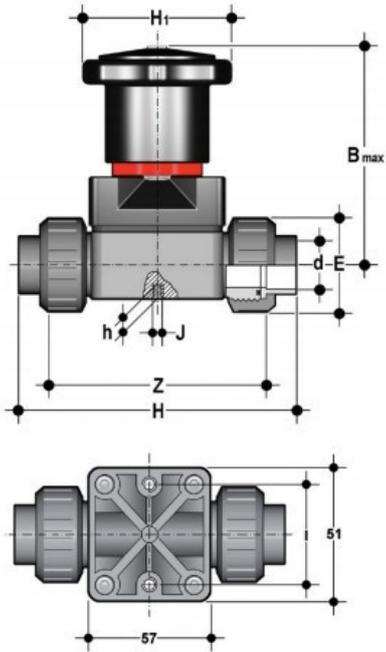
Компактный мембранный клапан CMFV ПВХ с резьбовыми окончаниями, EPDM, FIP d15 (DN15)
