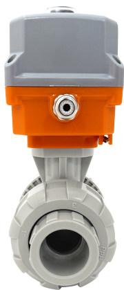
Шаровой кран IVKD ПП-гомополимер с эл.приводом 24V DC, муфтовые окончания, FKM, IPS d75 (DN65)
