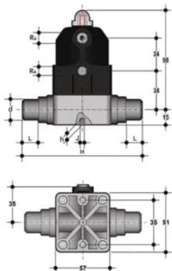
Компактный мембранный клапан СМ с пневмоприводом НЗ с втулочными окончаниями
