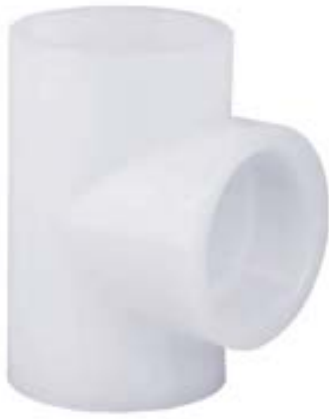
Тройник ПВДФ для раструбной сварки 90° d32 PN 16
