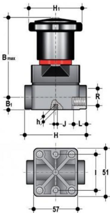
Компактный мембранный клапан СМ с резьбовыми окончаниями (уплотнение FKM / мембрана PTFE) PP-H R1/2" (DN15)
