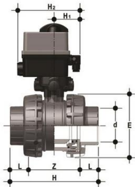
Шаровой кран VXE ПВХ с пневмоприводом, FKM, FIP d110 (DN90)
