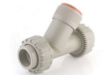
Угловой обратный клапан VR с муфтовыми окончаниями (уплотнение EPDM) PP-H d63 (DN50)
