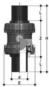
Шаровой обратный клапан SSEBEV ПВХ; с ПЭ патрубками; DN65-100, EPDM, FIP d75 (DN65)
