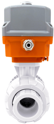
Шаровой кран IVKD ПВДФ с эл.приводом 220V AC, муфтовые окончания, FKM, IPS d110 (DN100)
