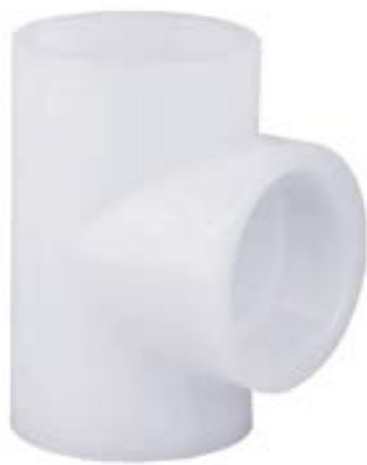
Тройник ПВХ для раструбной сварки 90° d20 PN 16
