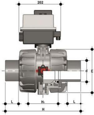
Шаровой кран VKD с эл.приводом 90-240V, втулочные окончания, DN65-100 (уплотнение FKM)
