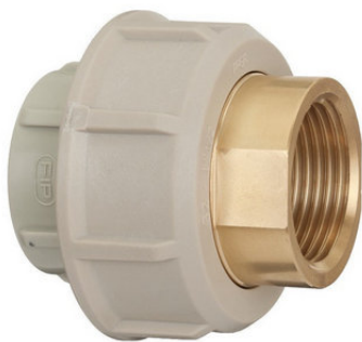
Муфта разборная переходная PP-H / латунь, ВР (EPDM) FIP 25x3/4 PN10
