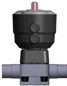
Мембранный клапан ДК ХПВХ с пневмоприводом НЗ, РН10 с втулочными окончаниями d40 (DN32)
