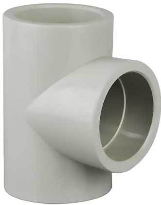
Тройник для раструбной сварки 90° PP-H IPS d50 PN10
