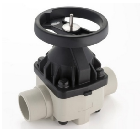
Мембранный клапан VMDM с втулочными окончаниями (уплотнение EPDM / мембрана EPDM) PP-H d110 (DN100)
