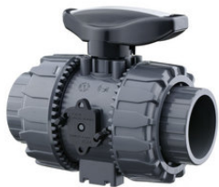
Шаровой кран ПВХ промышленного применения VKD с муфтовыми окончаниями, FKM, FIP d50 (DN40)
