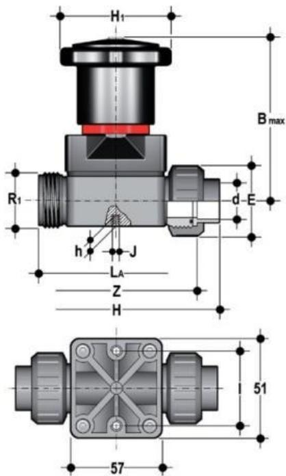
Компактный мембранный клапан CM с разборными муфтовыми окончаниями (уплотнение EPDM / мембрана EPDM) PP-H d20 (DN15)
