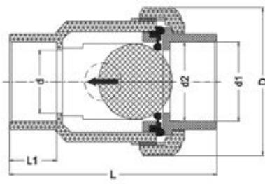
Шаровой обратный клапан с одним разборным окончанием ISR ПВХ; с муфтовыми окончаниями, FKM, IPS d50 (DN40)
