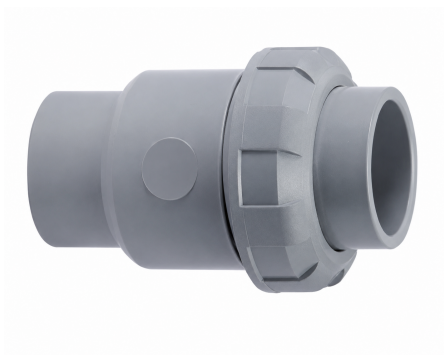
Шаровой обратный клапан с одним разборным окончанием ISR ХПВХ; с муфтовыми окончаниям, EPDM, IPS d40 (DN32)
