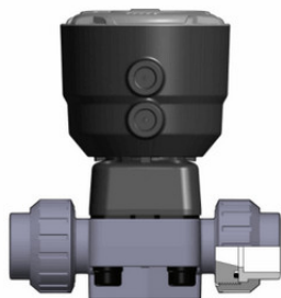
Мембранный клапан DK с пневмоприводом НЗ, РН6 с муфтовыми окончаниями (уплотнение EPDM/мембрана EPDM) PP-H d40 (DN32)
