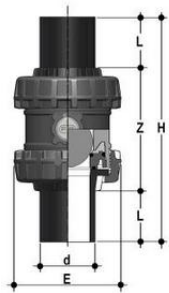
Шаровой обратный клапан SSEBEV ПВХ; с ПЭ патрубками; DN65-100, FKM, FIP d90 (DN80)
