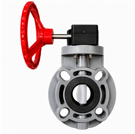
Затвор дисковый в корпусе FRPP (диск - ПВДФ) с редуктором промышленного применения FKM IPS d160 (DN150)
