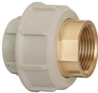
Муфта разборная переходная PP-H / латунь, ВР (EPDM) FIP 32x1 PN10
