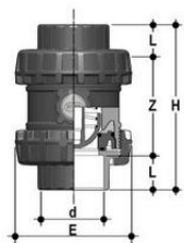
Пружинный шаровой обратный клапан SSE ХПВХ с муфтовыми окончаниями, DN65-100 d110 (DN90)
