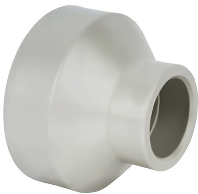
Муфта переходная для раструбной сварки PP-H IPS 110x75 PN10
