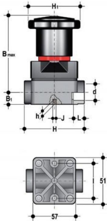
Компактный мембранный клапан CM ПВХ с пневмоприводом НЗ, муфтовые окончания, FKM, FIP d20 (DN15)
