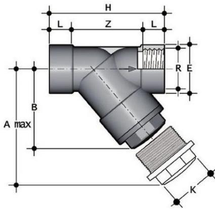
Грязевый фильтр из серого ПВХ с резьбовыми окончаниями, EPDM, FIP R2½" (DN65)
