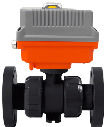
Шаровой кран IVKD ПВХ с эл.приводом 220V AC, фланцевые окончания, EPDM, IPS d75 (DN65)
