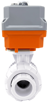
Шаровой кран IVKD ПВДФ с эл.приводом 220V AC, муфтовые окончания, FKM, IPS d110 (DN100)
