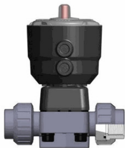
Мембранный клапан ДК ХПВХ с пневмоприводом НО, PN10, резьбовые окончания R1/2" (DN15)
