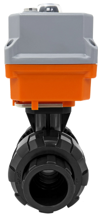
Шаровой кран IVKD ПБХ с эл.приводом 220V AC, муфтовые окончания, FKM, IPS d50 (DN40)
