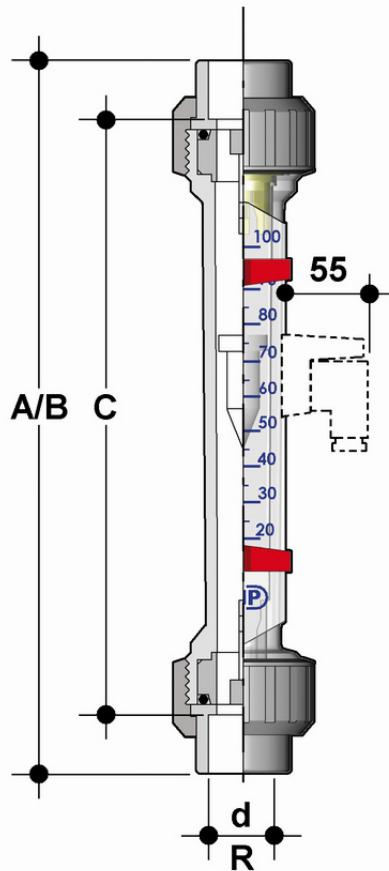
FC ротаметр для воздуха; корпус: трогамид; поплавок с магнитом d20
