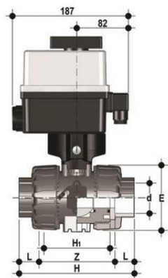
Шаровой кран для регулирования потока VKR ПВХ с эл.приводом 24V AC 12VDC, муфтовые окончания, FKM, FIP d20 (DN15)
