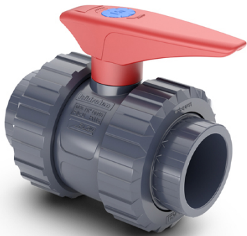
Шаровой кран ПВХ промышленного применения с муфтовыми окончаниями, EPDM, Hidroten d90 (DN80)
