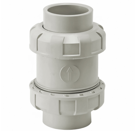
Обратный клапан шаровой с муфтовыми окончаниями PP-H IPS (EPDM) d75
