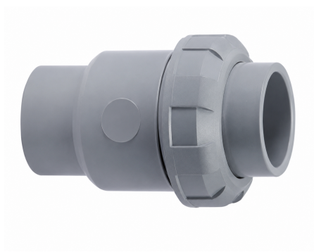
Шаровой обратный клапан с одним разборным окончанием ISR ХПВХ; с муфтовыми окончаниям, EPDM, IPS d32 (DN25)
