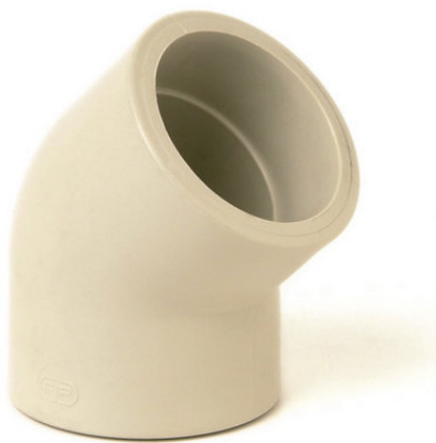
Отвод 45° для раструбной сварки PP-H FIP PN10
