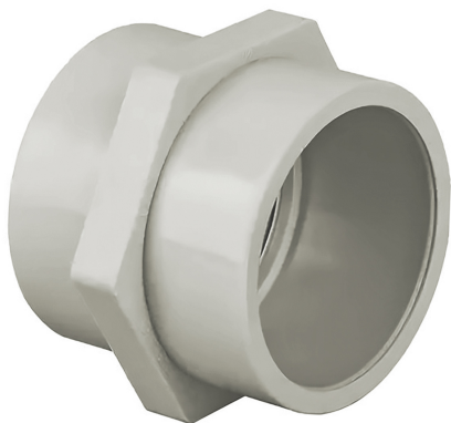
Муфта переходная для раструбной сварки с ВР РР-Н IPS d32 PN10
