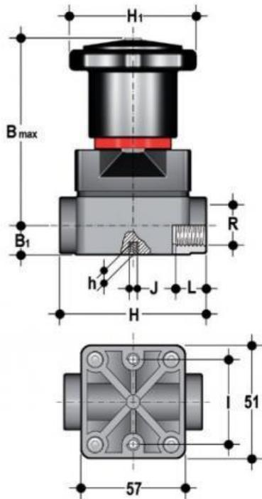
Компактный мембранный клапан CM с резьбовыми окончаниями (уплотнение EPDM / мембрана EPDM) PP-H R3/8" (DN12)
