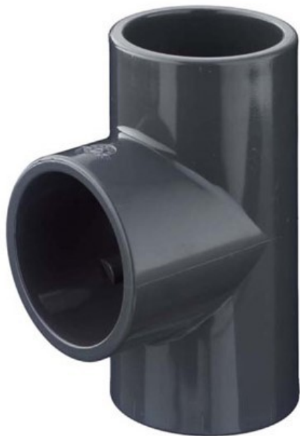
Тройник равнопроходной клеевой 90° ПВХ IPS d315
