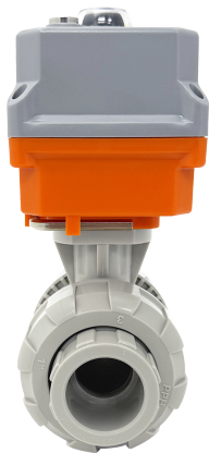
Шаровой кран IVKD ПП-гомополимер с эл.приводом 24V DC, муфтовые окончания, EPDM, IPS d63 (DN50)
