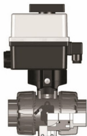
Шаровой кран для регулирования потока VKR ПВХ с эл.приводом 24V AC 12VDC, муфтовые окончания, EPDM, FIP d20 (DN15)
