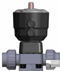
Мембранный клапан ДК ПБХ с пневмоприводом НЗ, PN10, резьбовые окончания, FKM, FIP R1" (DN25)
