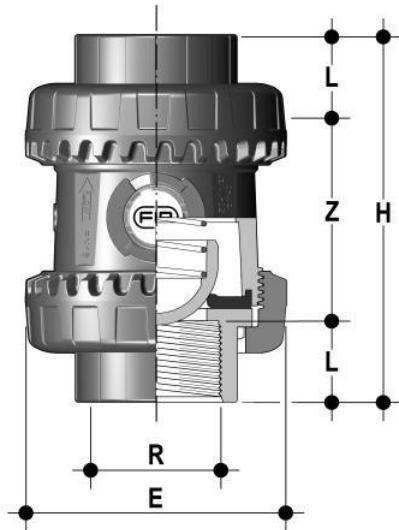
Пружинный шаровой обратный клапан SSEFV ПВХ; с муфтовыми окончаниями, EPDM, FIP R3/8" (DN10)
