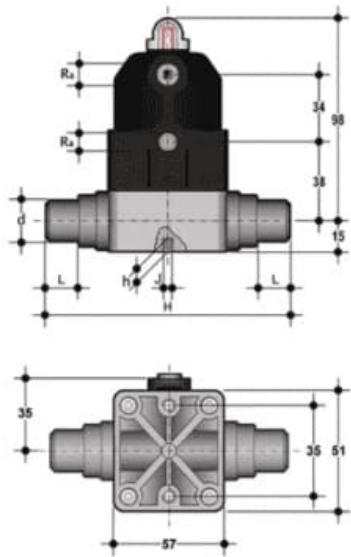
Компактный мембранный клапан СМ с пневмоприводом ДвД с муфтовыми окончаниями
