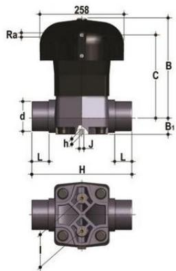
Мембранный клапан VM ХПВХ с пневмоприводом двойного действия, втулочные окончания d90 (DN80)
